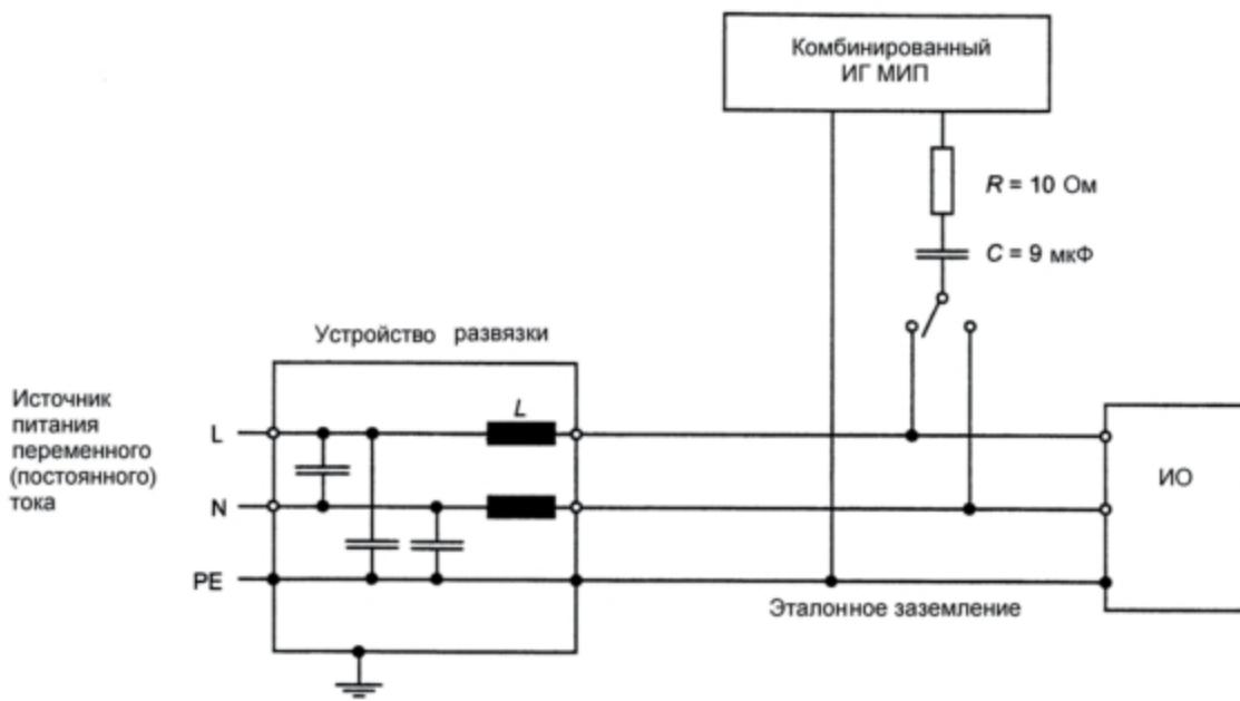
L – фазный провод; N – нейтральный провод; PE – защитное заземление
