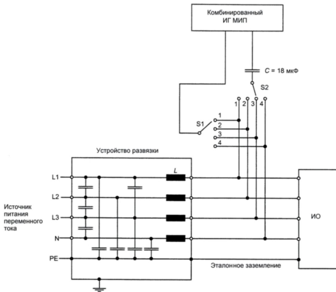
L1, L2, L3 – фазные провода; N – нейтральный провод; PE – защитное заземление; S1, S2 – переключатели
