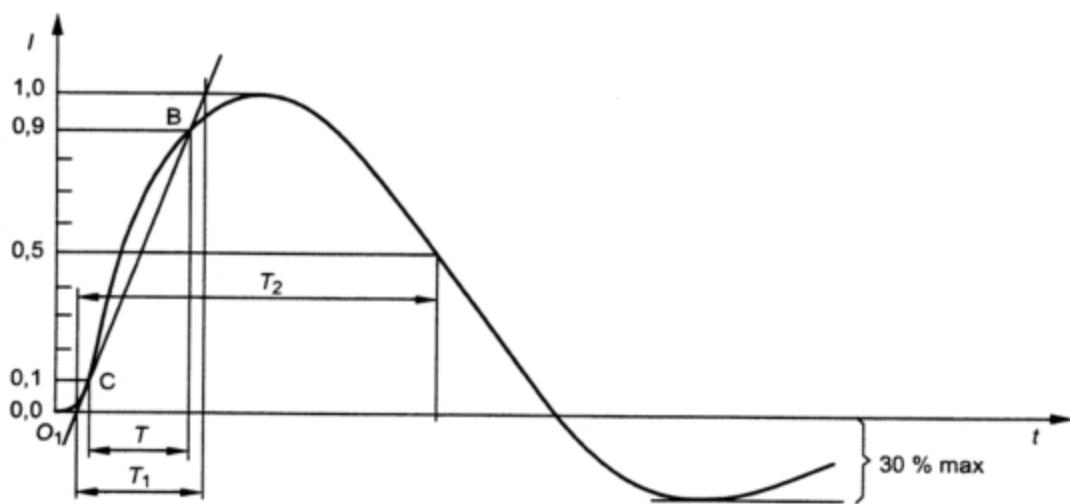
Длительность фронта импульса:  $T_1 = 1,25 \times T = 8 \text{ мкс} \pm 20 \%$ .
