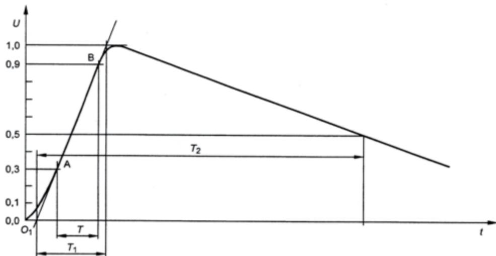
Длительность фронта импульса:  $T_1 = 1,67 \times T = 10 \text{ мкс} \pm 30\%$ .
