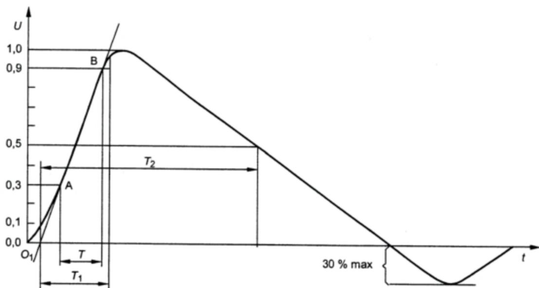
Длительность фронта импульса:  $T_1 = 1,67 \times T = 1,2 \text{ мкс} \pm 30 \%$ .
