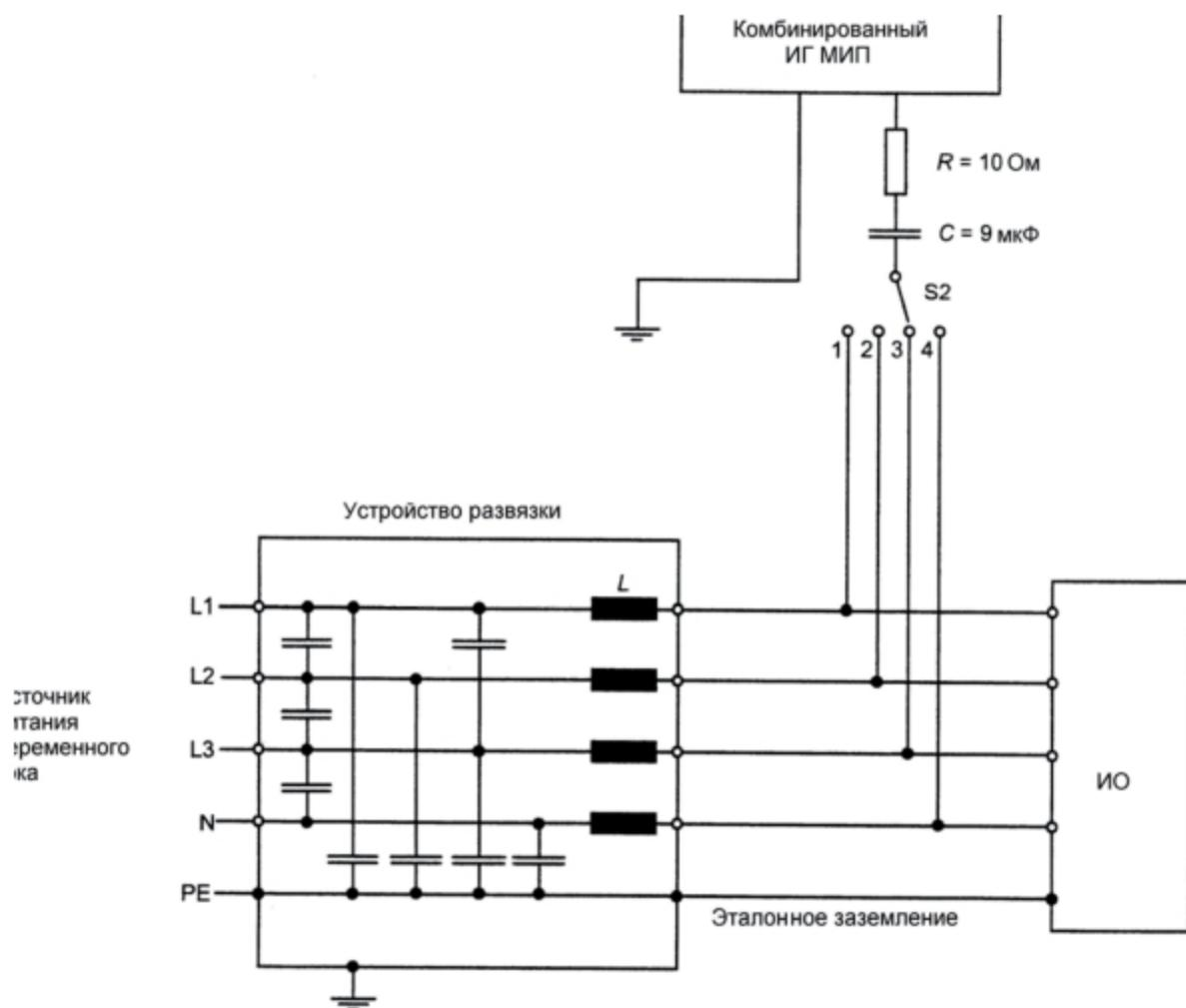
L1, L2, L3 – фазные провода; N – нейтральный провод; PE – защитное заземление; S2 – переключатель
