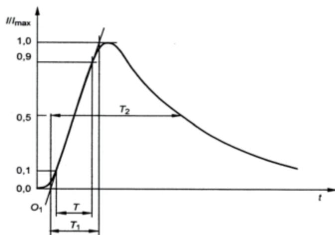
Длительность фронта импульса:  $T_1 = 1,25 \times T = 5 \text{ мкс} \pm 20\%$ .
