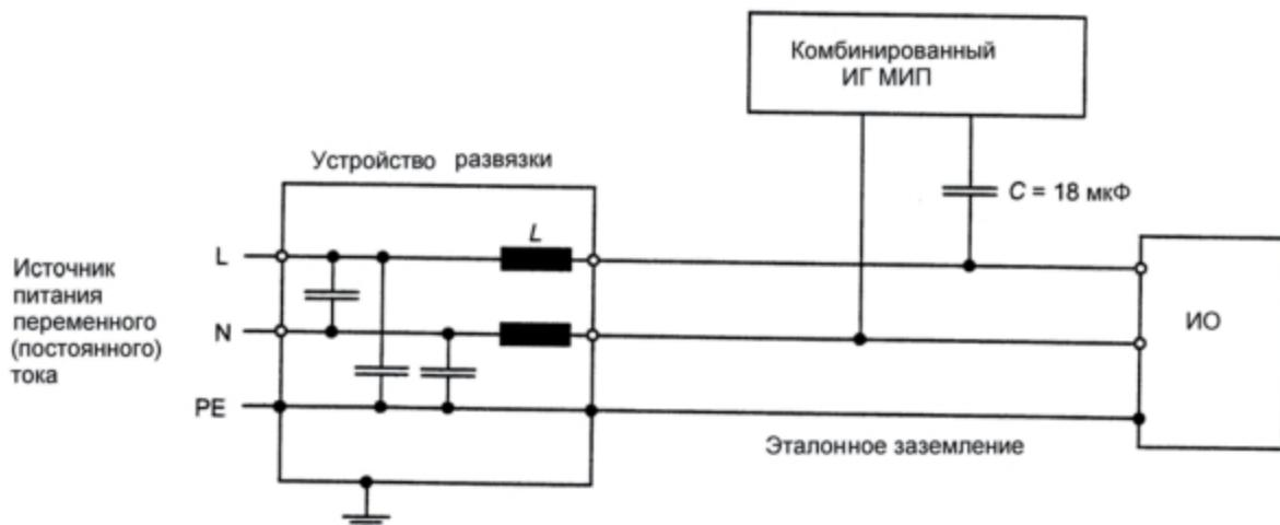
L – фазный провод; N – нейтральный провод; PE – защитное заземление
