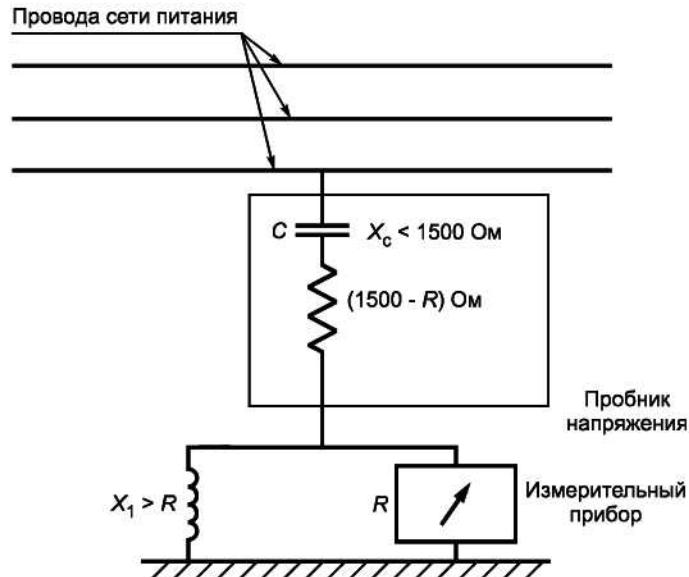
Рисунок 4 — Схема измерения напряжения ИРП на сетевых зажимах с помощью пробника напряжения (см. 6.2.3)
