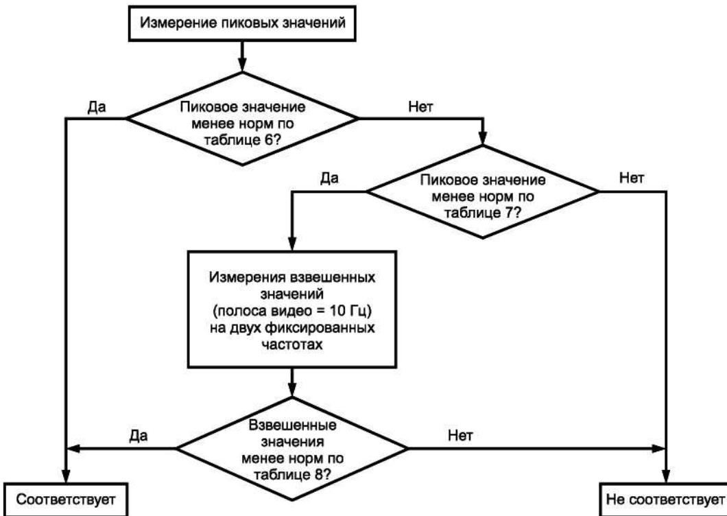
Рисунок 5 — Алгоритм принятия решения по результатам измерений излучаемых ИРП в полосе частот от 1 до 18 ГГц ПНМБ ВЧ устройств класса А и класса Б, группы 2, работающих на частотах выше 400 МГц
