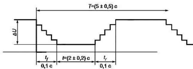
Рисунок 16 — Определение времени спада  $t$  и времени возрастания  $t$  при формировании ступенчатых изменений напряжения
