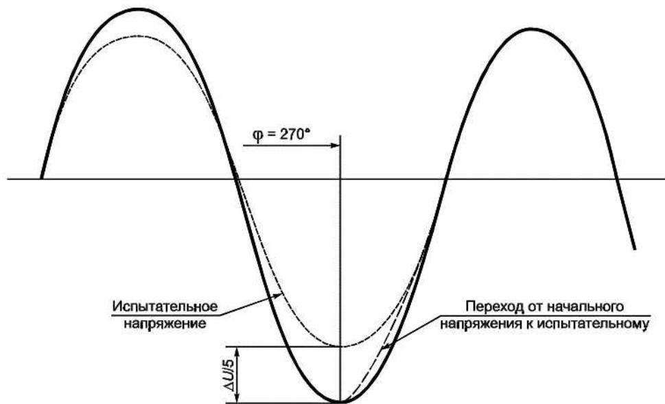
Рисунок 1б — Изменение напряжения в течение 0,25 периода при образовании  $t$  и  $t$
