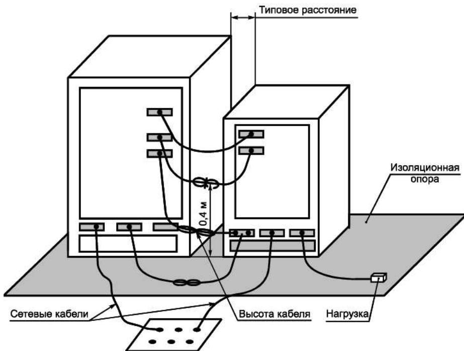
Рисунок 11 — Размещение ИО: напольное оборудование, измерение излучаемых ИРП
