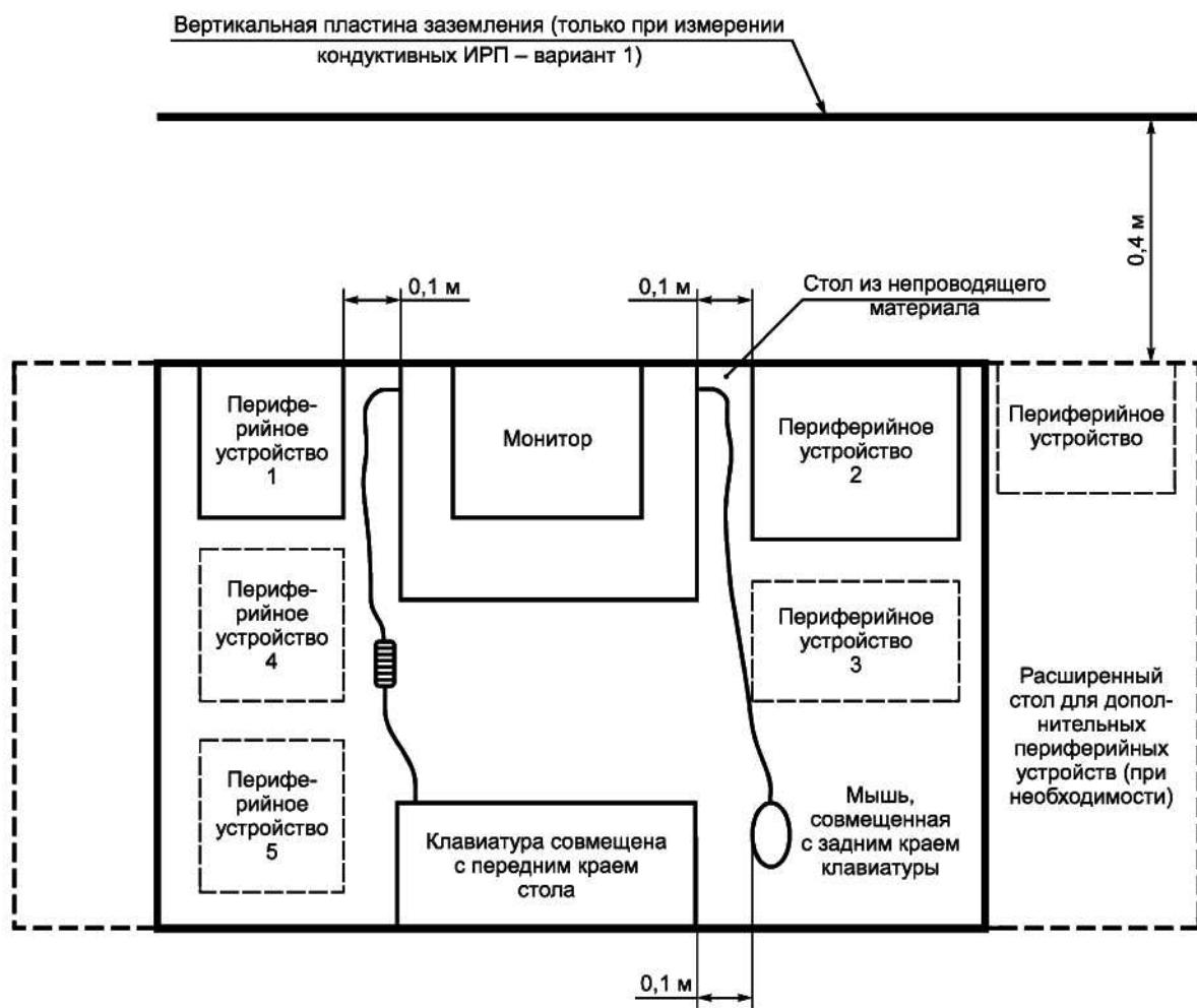
Рисунок 4 — Размещение ИО: настольное оборудование, измерение кондуктивных и излучаемых ИРП (вид сверху)
