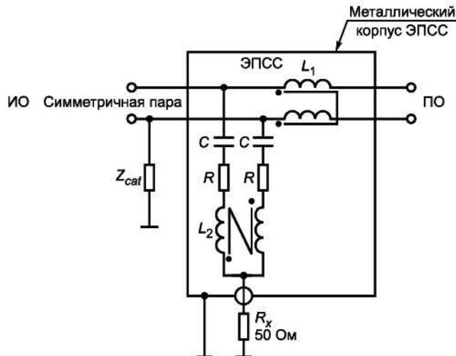
$C = 47 \text{ мкФ}$ ;  $R = 200 \text{ Ом}$ ;  $L_1 = 2 \cdot 38 \text{ мГн}$ ;  $L_2 = 2 \cdot 38 \text{ мГн}$ ;  $R_x$  — вход измерителя ИРП;
