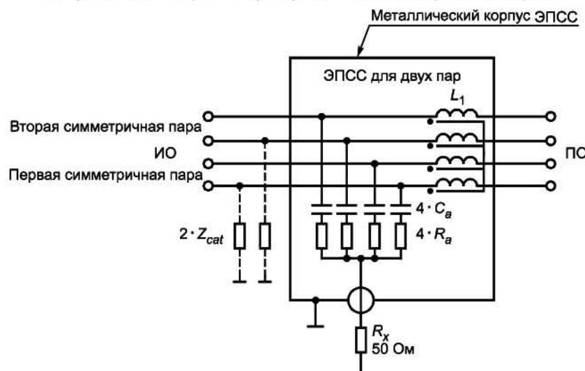
$C_a = 33 \text{ нФ}$ ;  $R_a = 400 \Omega$ ;  $L_1 = 4 \cdot 7 \text{ мГн}$ ;  $R_x$  — вход измерителя ИРП; ПО — подключаемое оборудование;
