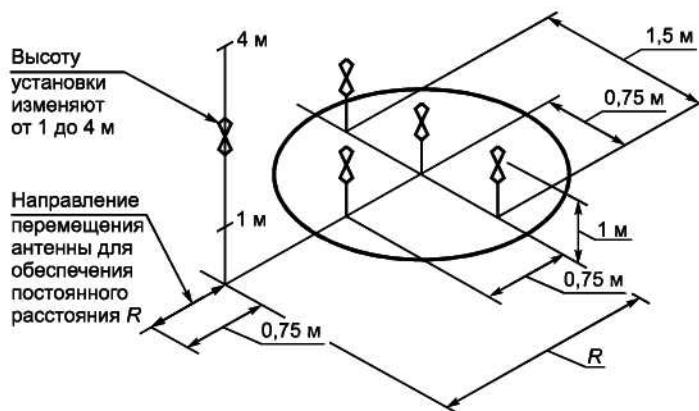
*R* — расстояние между вертикальными проекциями центров передающей и приемной антенн
