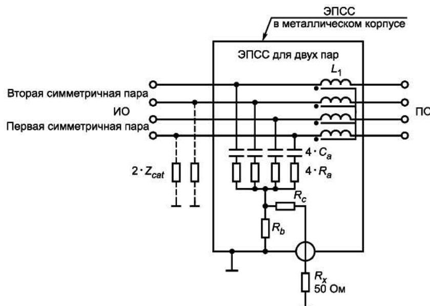
$C_a = 33 \text{ нФ}$ ;  $R_a = 576 \Omega$ ;  $R_b = 6 \Omega$ ;  $R_c = 44 \Omega$ ;  $L_1 = 4 \cdot 7 \text{ мГн}$ ;  $R_x$  — вход измерителя ИРП;
