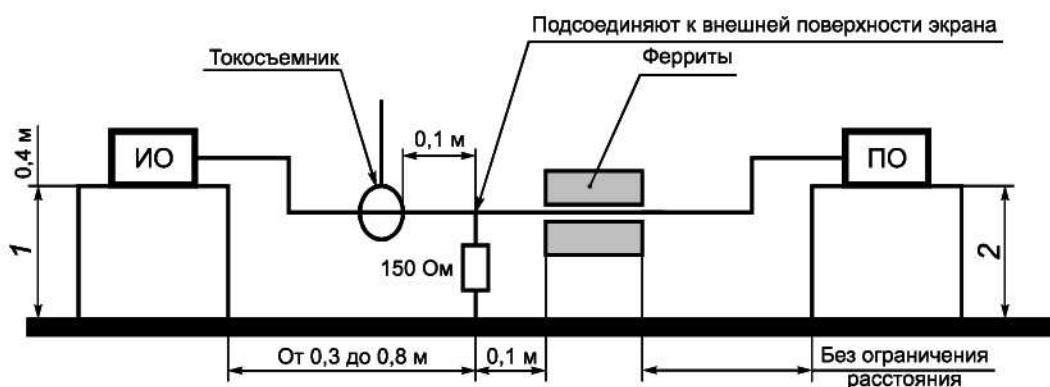
ИО — испытуемое оборудование; ПО — подключаемое оборудование; 1 — расстояние до пластины заземления (вертикальной или горизонтальной); 2 — расстояние до пластины заземления, не являющееся критичным
