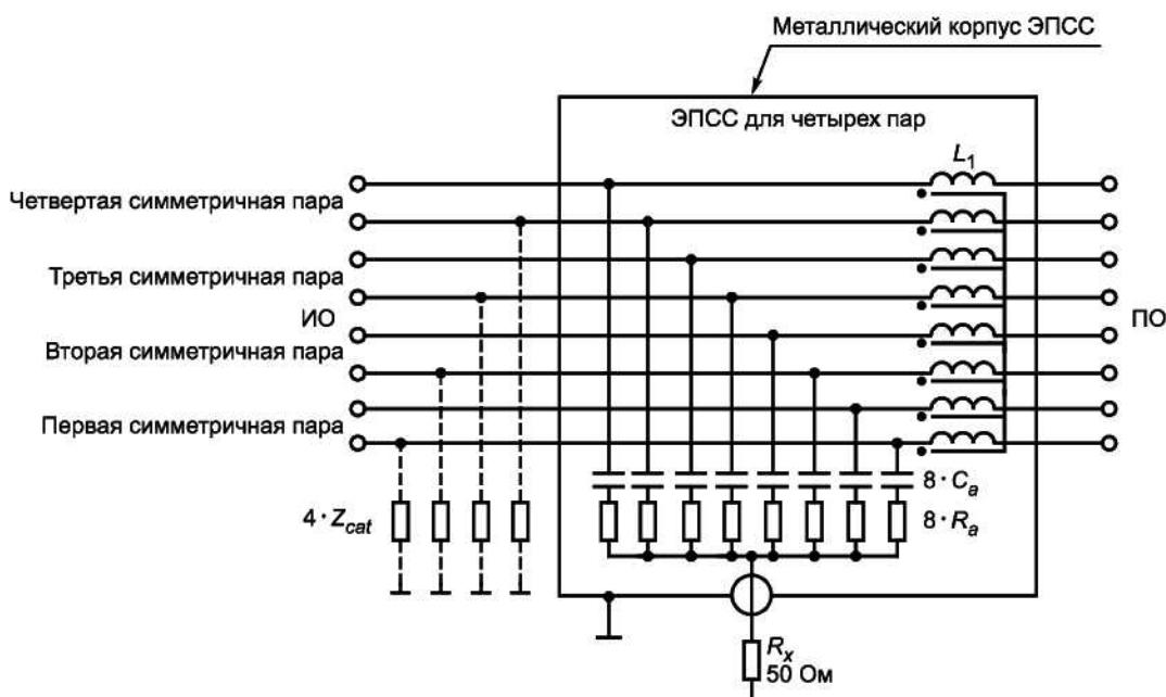
$C_a = 33 \text{ нФ}$ ;  $R_a = 800 \Omega$ ;  $L_1 = 8 \cdot 7 \text{ мГн}$ ;  $R_x$  — вход измерителя ИРП;
