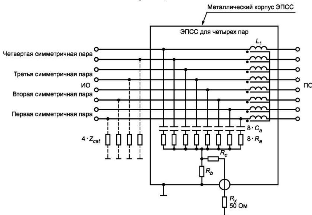
$C_a = 33 \text{ нФ}$ ;  $R_a = 1152 \text{ Ом}$ ;  $R_b = 6 \text{ Ом}$ ;  $R_c = 44 \text{ Ом}$ ;  $L_1 = 8 \cdot 7 \text{ мГн}$ ;  $R_x$  — вход измерителя ИРП;
