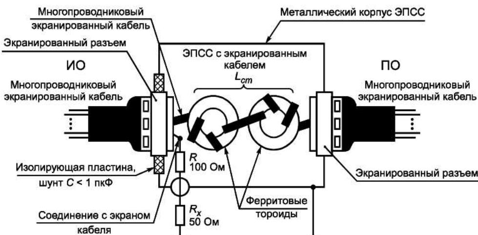
ПО — подключаемое оборудование; ИО — испытуемое оборудование;  $R_x$  — вход измерителя ИРП; дроссель общего несимметричного режима  $L_{cm} > 9 \text{ мГн}$ , общий паразитный шунт  $C < 1 \text{ пКФ}$
