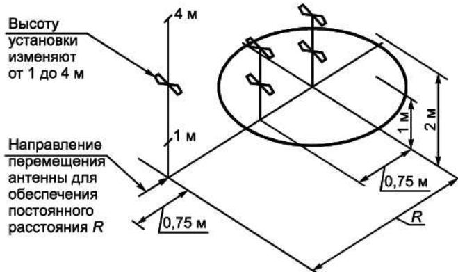
*R* — расстояние между вертикальными проекциями центров передающей и приемной антенн
