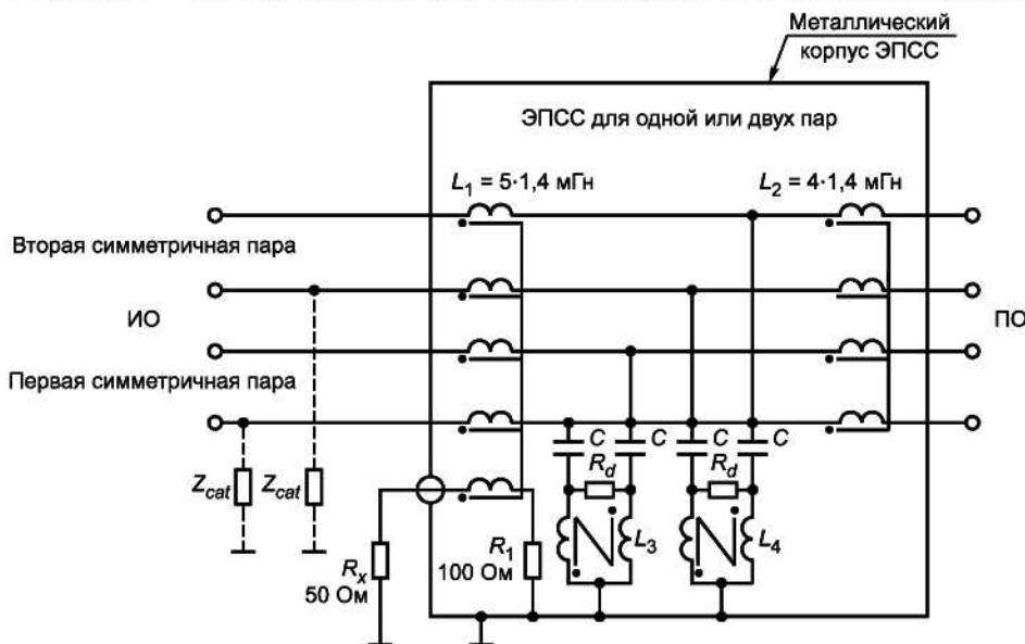
$C = 82 \text{ нФ}$ ;  $L_3 = 2 \cdot 3,1 \text{ мГн}$ ;  $L_4 = 2 \cdot 3,1 \text{ мГн}$ ;  $R_d = 390 \text{ Ом}$ ;  $R_x$  — вход измерителя ИРП;
