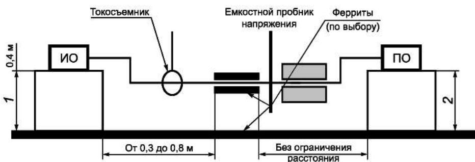
ИО — испытуемое оборудование; ПО — подключаемое оборудование; 1 — расстояние до пластины заземления (вертикальной или горизонтальной); 2 — расстояние до пластины заземления, не являющееся критичным
