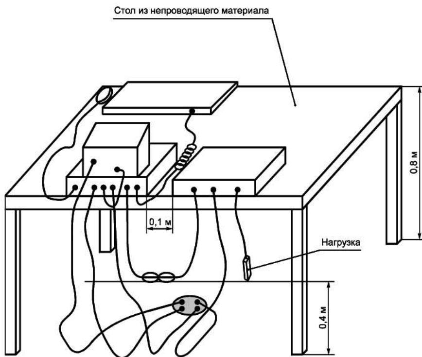
Рисунок 10 — Размещение ИО: настольное оборудование, измерение излучаемых ИРП
