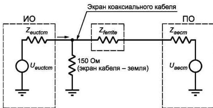
$V_{euctsm}$  — общее несимметричное напряжение ИРП, создаваемое ИО;  $Z_{euctsm}$  — общее несимметричное полное сопротивление ИО;
