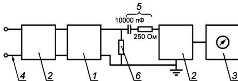
1 — устройство питания электрического ограждения; 2 — V-образный эквивалент сети питания (см. 5.1.2); 3 — измерительный приемник; 4 — провода к сети электропитания или к батарее; 5 — элементы эквивалентной схемы ограждения (полное сопротивление нагрузки 300 Ом обеспечивается резистором 250 Ом, соединенным последовательно с сопротивлением 50 Ом V-образного эквивалента сети питания); 6 — резистор утечки сопротивлением 500 Ом (следует добавить в эквивалентную схему, указанную выше в позиции 5)
