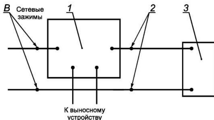
1 — регулирующее управляемое устройство; 2 — зажимы нагрузки; 3 — нагрузка
