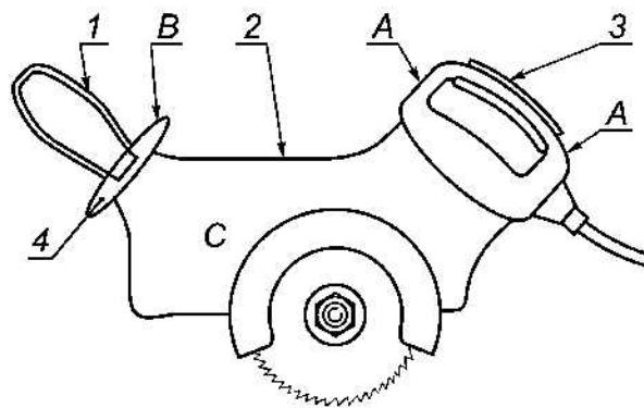
1 — металлическая фольга, намотанная вокруг рукоятки; 2 — металлический корпус; 3 — металлическая фольга, намотанная вокруг рукоятки; 4 — предохранитель — упор (если имеется); *A*, *B*, *D* — рукоятки из изоляционного материала
