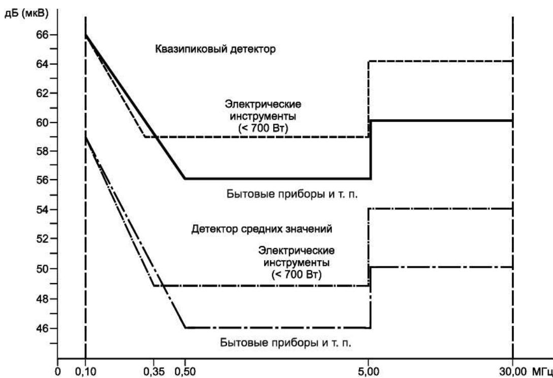
**П р и м е ч а н и е** — Для электрического инструмента номинальной мощностью от 700 до 1000 Вт норма превышает приведенную на графике на 4 дБ инструмента номинальной мощностью более 1000 Вт — на 10 дБ.
