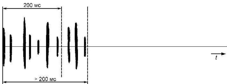
**П р и м е ч а н и е** Отдельные импульсы длительностью менее 200 мс, разделенные интервалами, каждый из которых менее 200 мс, продолжающиеся более 200 мс и наблюдаемые на выходе ПЧ измерительного приемника.
