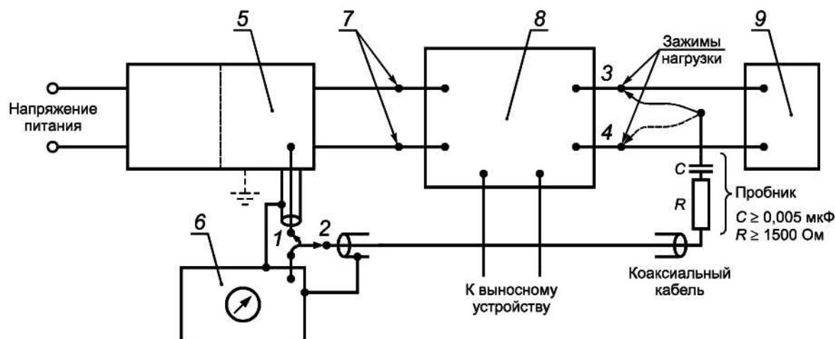
1 — положение переключателя при измерениях на сетевых зажимах; 2 — положение переключателя при измерениях на зажимах нагрузки; 3,4 — наиболее приемлемые соединения во время измерений на зажимах нагрузки; 5 — V-образный эквивалент сети питания 50 Ом/50 мкГн; 6 — измерительный приемник; 7 — сетевые зажимы; 8 — регулирующее управляемое устройство; 9 — нагрузка
