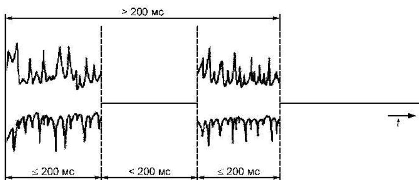
**П р и м е ч а н и е** Две ИРП, разделенные интервалом менее 200 мс и имеющие полную длительность более 200 мс, наблюдаемые на выходе ПЧ измерительного приемника.
