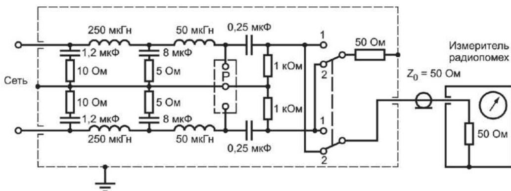
P — разъем для подключения испытуемого устройства
