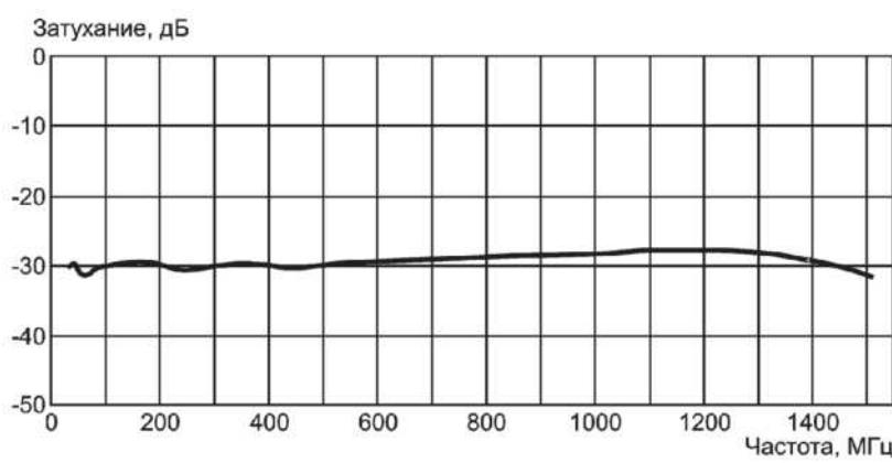
Рисунок А.4 — Типовая характеристика вносимого затухания развязывающего трансформатора с рабочей полосой частот от 46 МГц до 1,5 ГГц
