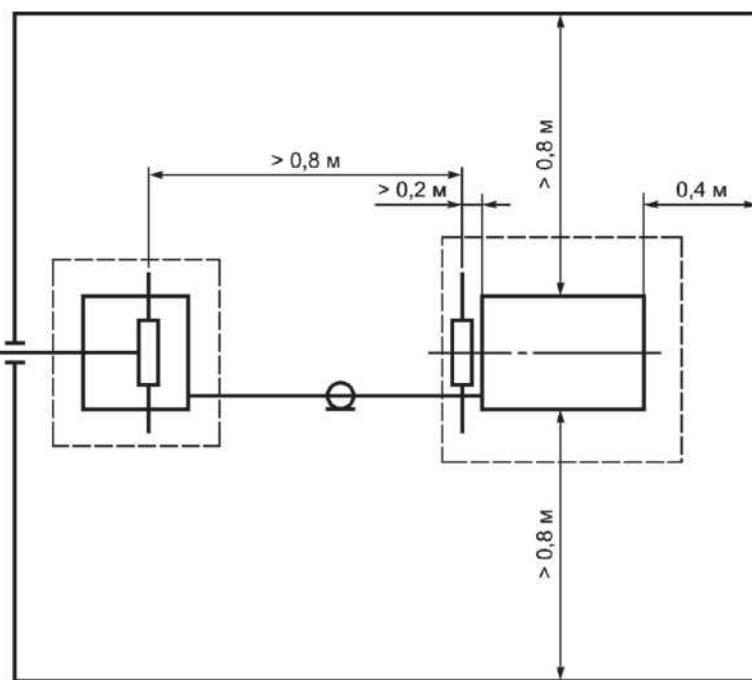
Рисунок 6 — Расположение аппаратуры в экранированной камере при измерении напряжения ИРП на сетевых зажимах (вид сверху)
