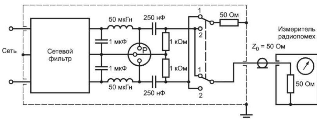
P — разъем для подключения испытуемого устройства
