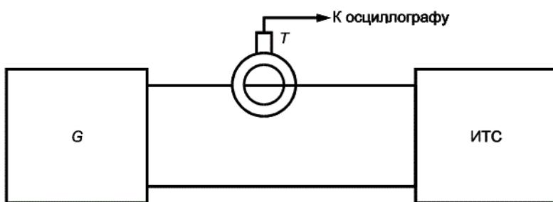
G — ИГ прерываний напряжения; T — токосъемник
