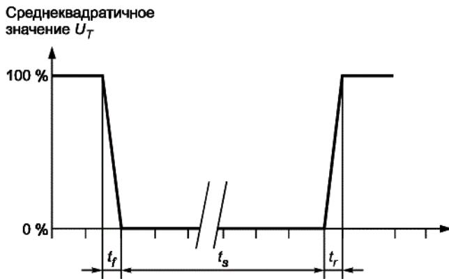
$t_f$  — время нарастания напряжения;  $t_r$  — время понижения напряжения;  $t_s$  — время выдержки на пониженном напряжении
