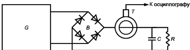
G — ИГ прерываний напряжения с переключением при  $90^\circ$  и  $270^\circ$ ; T — токосъемник; B — выпрямительный мост;
