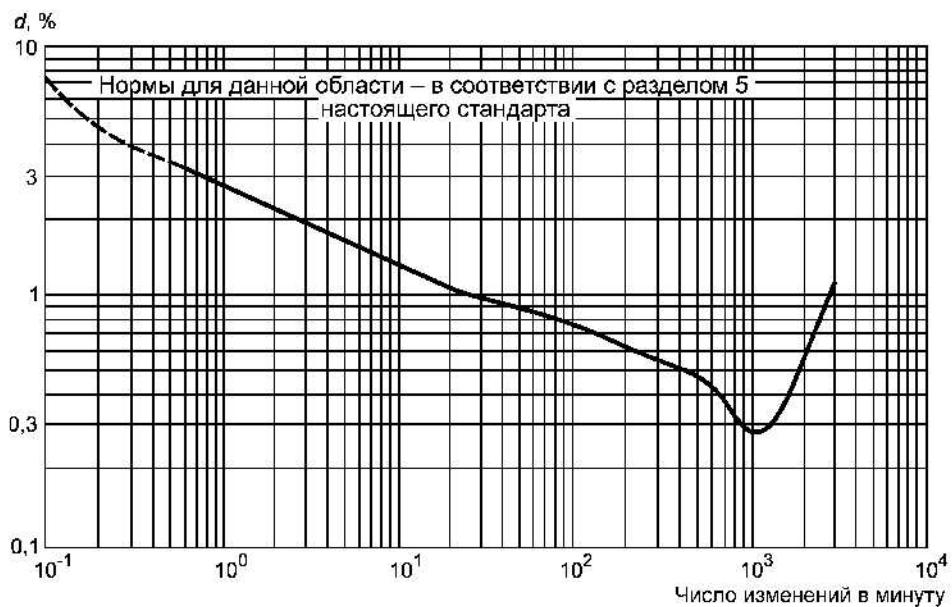
П р и м е ч а н и е — Частота повторения изменений напряжения  $1200 \text{ мин}^{-1}$  соответствует фликеру с частотой  $10 \text{ Гц}$
