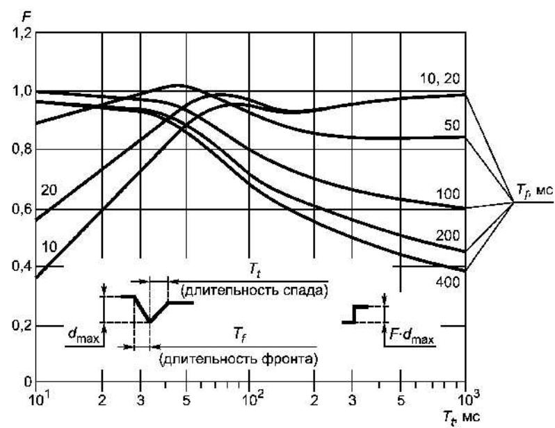
П р и м е ч а н и е —  $T_t = t_3 - t_2$ ,  $T_f = t_2 - t_1$  (см. рисунок 3)
