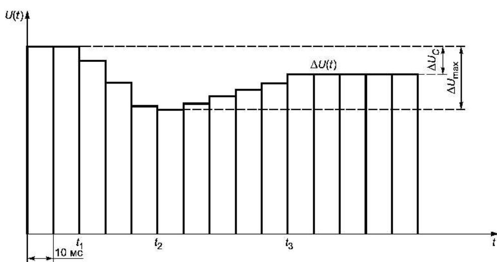
Рисунок 2 — Схема определения огибающей среднеквадратичных значений напряжения
