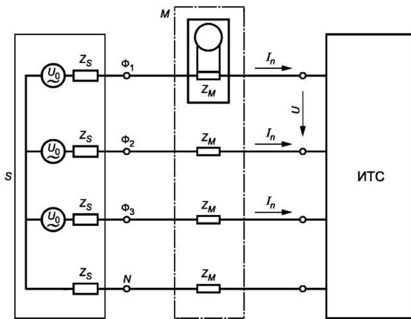
$S$  — источник электропитания;  $U_0$  — напряжение холостого хода источника электропитания;  $Z_S$  — внутреннее полное сопротивление источника электропитания;  $M$  — средство измерений;  $Z_M$  — входное полное сопротивление средства измерений;  $\Phi_1, \Phi_2, \Phi_3$  — фазные провода;  $N$  — нейтральный провод;  $I_n$  — гармоническая составляющая линейного тока  $n$ -го порядка;  $U$  — испытательное напряжение (показано между фазными проводами  $\Phi_1$  и  $\Phi_2$ ).
