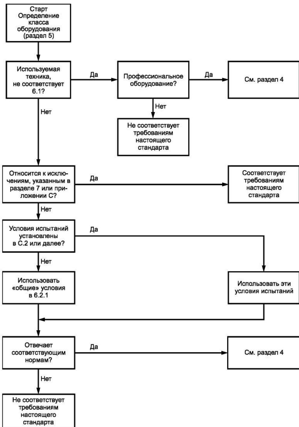
Рисунок 1 — Алгоритм для определения соответствия
