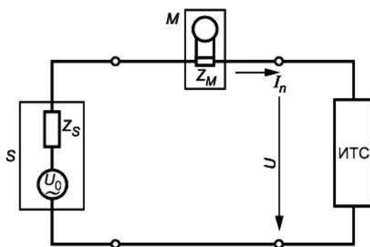
$S$  — источник электропитания;  $U_0$  — напряжение холостого хода источника электропитания;  $Z_S$  — внутреннее полное сопротивление источника электропитания;  $M$  — средство измерений;  $Z_M$  — входное полное сопротивление средства измерений;  $I_n$  — гармоническая составляющая линейного тока  $n$ -го порядка;  $U$  — испытательное напряжение
