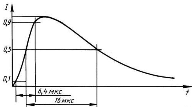
Рисунок 2 — Форма импульса выходного тока ИГ
