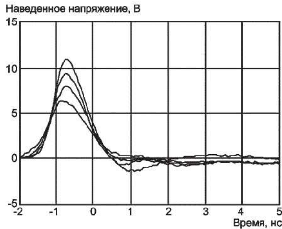
Рисунок D.4 – Зависимость от времени напряжения, наведенного электростатическим разрядом в полукруглой петле
