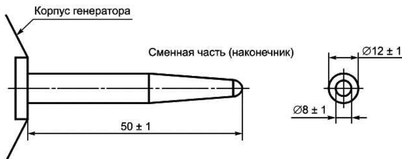
а) Разрядный наконечник для испытания методом воздушного разряда
