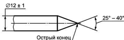
б) Разрядный наконечник для испытания методом контактного разряда
